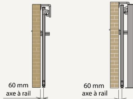
Vue de côté coulissant Poteau de guidage vue de côté
